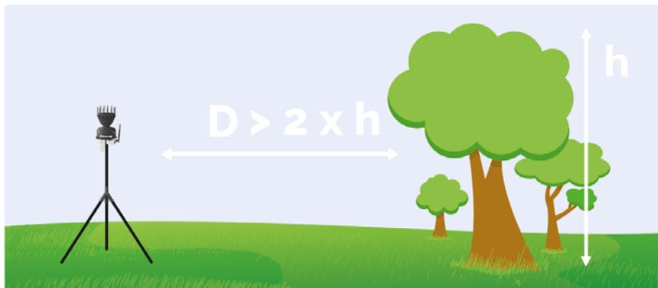
Para asegurarse una transmisión de datos fiable con su dispositivo, debe cumplir determinadas reglas de instalación:
